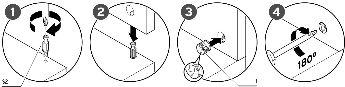
Aufbau | Montage | Montaggio | Assembly | Montáž | Montaż | Montáž | Összeszerelés | Kurulum
